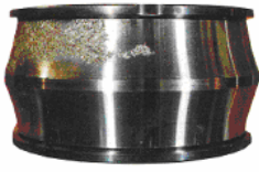
قطعه: کتس، داخلی، یک رولربیرینگ بشکه ای نشانه: پوسته شدن تهازی یک ردیف از محل های عبور ساچمه ها علت: روانکاری ناقص
