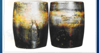
قطعه: رولرهای بیرینگ شکل قبل نشانه: تغییر رنگ و ذوب شدن سطح رولرها و چسبیدن ذرات فرسایشی جدا شده از قفسه روی سطح رولرها علت: روانکاری ناقص
