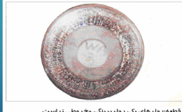
قطعه: رولرهای یک رولبرینگ مخروطی تراست نشانه: ترک های حرارتی روی سطح بزرگتر رولرها اتفاق افتاده علت: حرارت ایجاد شده ناشی از لغزیدن رولرها روی کس داخلی همراه پاروئنگاری ناقص
