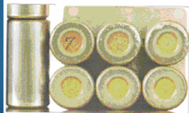
قطعه: رولرهای یک رولبرینگ دوردیفه استوانه ای نشانه: خط افتادن روی سطح خارجی رولرها علت: یروغنکاری ناقص و نیروی محوری زیاد
