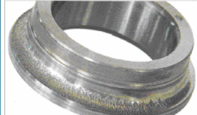
قطعه: کتس داخلی یک بال بیرینگ تماس زاویه ای نشانه: پوسته شدن در قسمت اطراف نیمه محل حرکت ساچمه ها اتفاق افتاده علت: روانکاری ناقص ناشی از ورود رسوبات خاک کننده به طرف هوزینگ
