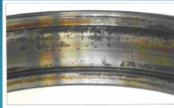
قطعه: کس خارجی یک رولبرینگ مخروطی نشانه: زنگ زدگی روی سطح لبه ها و محل ساچمه ها علت: نقصان روغنکاری ناشی از ورود آب
