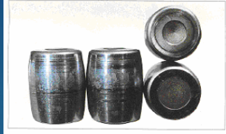
قطعه: رولرهای بیرینگ شکل قبل نشانه: پوسته شدن دایره ای شکل روی قسمت وسط رولرها ایجاد شده است علت: روانکاری ناقص
