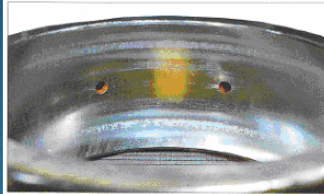
قطعه: کتس خارجی یک رولربیرینگ بشکه ای نشانه: پوسته شدن در نزدیکی لبه کتس داخلی روی محیط کتس ایجاد شده است علت: روانکاری ناقص
