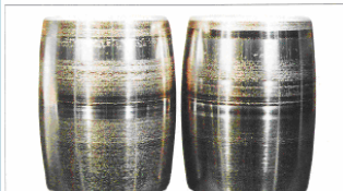
قطعه: رولرهای شکل قبلی نشانه: زبر شدن روی مرکز سطح رولرها اتفاق افتاده است علت: روانکاری ناقص
