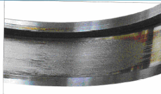
قطعه: کتس خارجی بیرینگ قبلی نشانه: زبر شدن روی محیط وسط و داخلی اتفاق افتاده علت: به دلیل زیاد بودن مقدار گریس داخل هوزینگ بیرینگ
